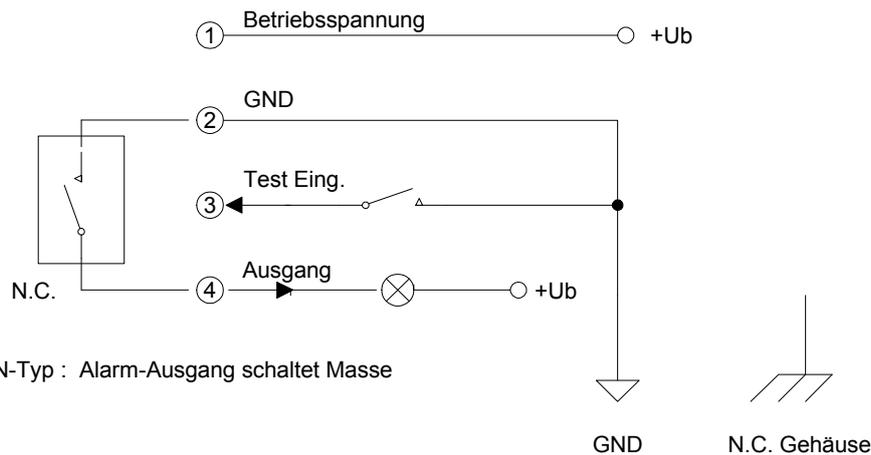
Tab. 3 N-Typ : Alarm-Ausgang schaltet Masse
