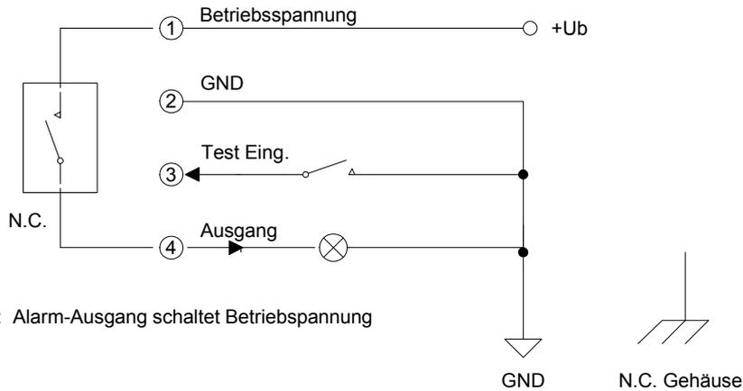
Tab. 3 P-Typ : Alarm-Ausgang schaltet Betriebsspannung
